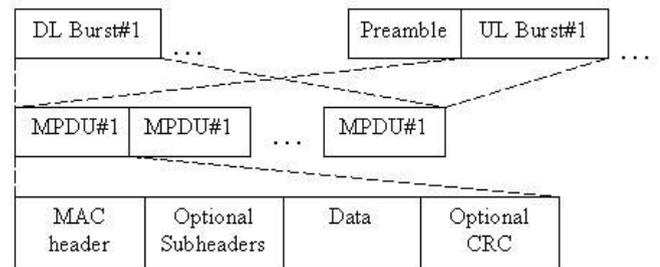
Fig. 4. MPDU frame format
